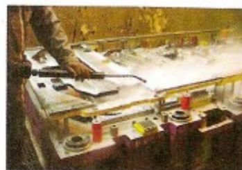
Nettoyage manuel d'outils d'emboutissage.
